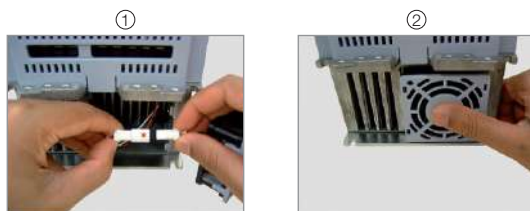
Figura 6.1: (a) y (b) Retirada del ventilador del disipador
