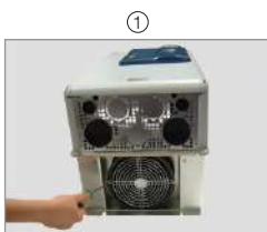
1 Remoção dos parafusos da grade do ventilador
