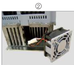
2 Remoção do ventilador
