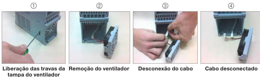
Figura 6.1: Retirada do ventilador do dissipador
