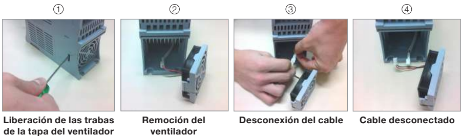
Figura 6.1: Retirada del ventilador del disipador
